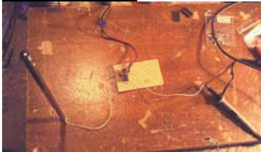
Le Premier oscillateur terminé, il faut y connecter une antenne, ici une sonde d'oscilloscope (sorte de crayon) permet de visualiser le signal de sortie de l'oscillateur. Malheureusement la sonde de l'oscilloscope perturbe l'oscillateur.
